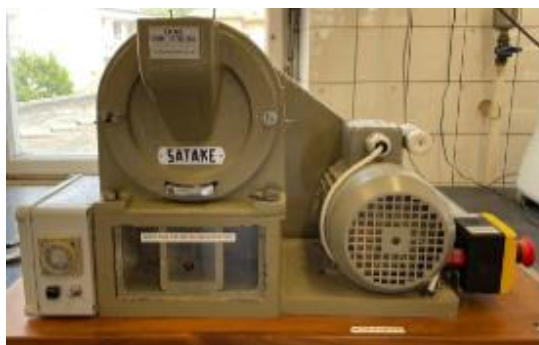
3. ábra Satake laboratóriumi tárcsás hántoló berendezés (saját fotó)
