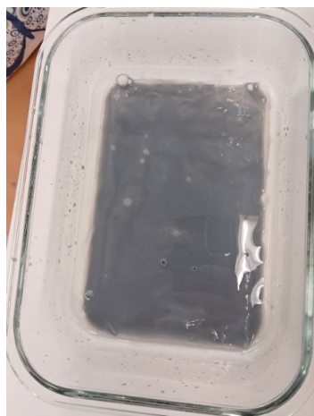
7. ábra: A TiO 2 /CNT-COOH tartalmú felületmódosító szuszpenzió a membrán felületén
