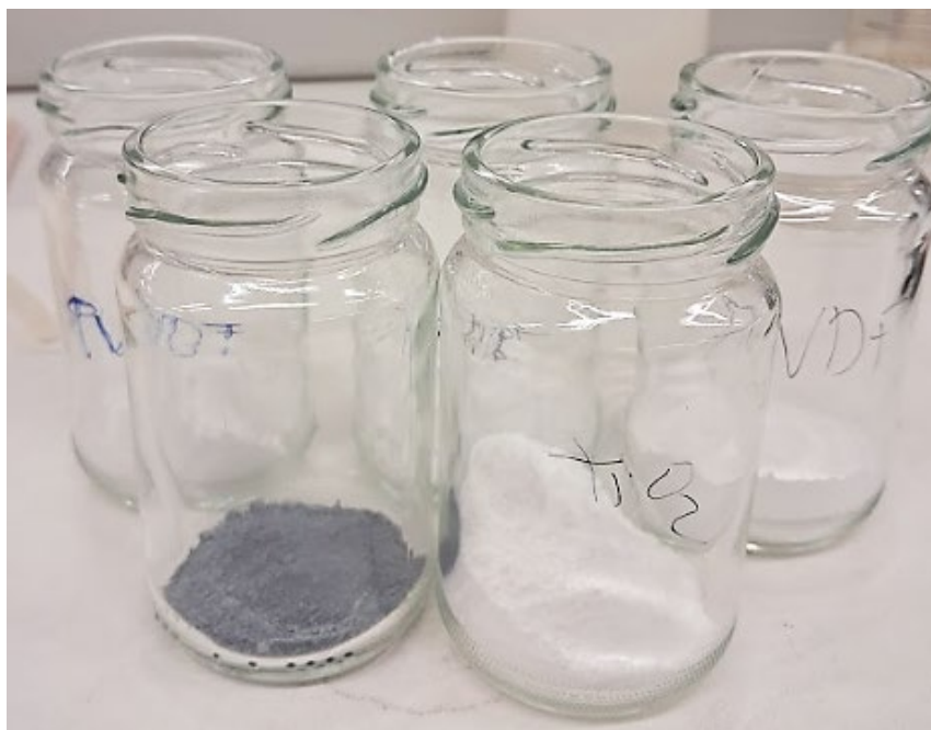
3. ábra: PVDF porok, \text{TiO}_2 és \text{TiO}_2/\text{CNT-COOH} kompozit kimérve a szárításhoz
