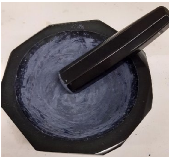
2. ábra: A \text{TiO}_2/\text{CNT-COOH}_{2\%} kompozit előállítása dörzsmozsárban
