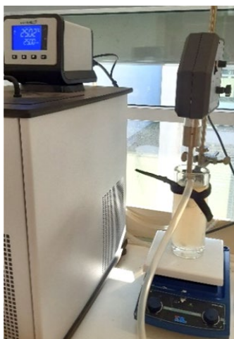
11. ábra: Hielscher UP200S ultrahangos homogenizáló készülék emulzió előállításakor
