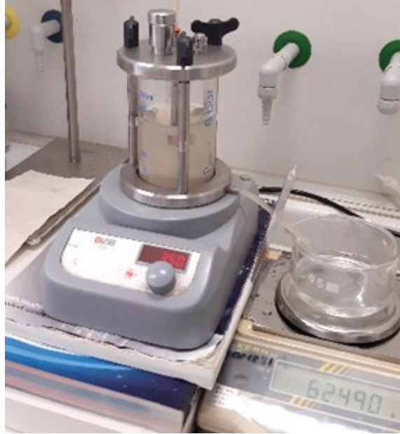
12. ábra: Membránszűrés a Millipore XFUF07601 reaktorral
