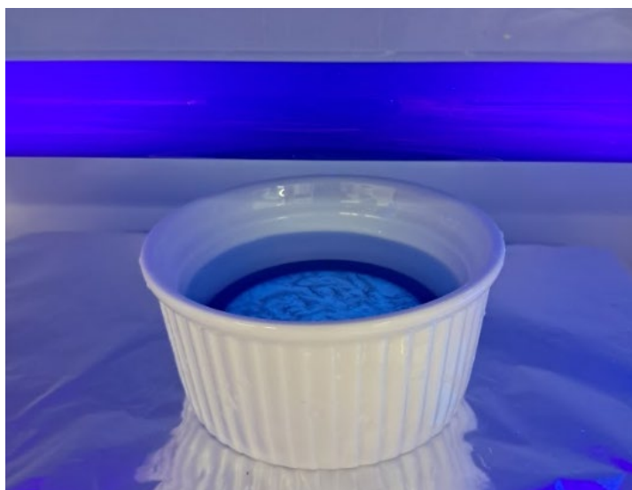
25. ábra: A valós olajszennyezett víz szűrésére felhasznált TiO 2 /CNT-COOH kompozittal felületmódosított membrán besugárzása UV-A fénnel
