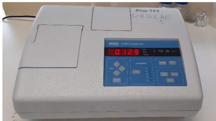
13. ábra: Hach 2100N típusú nefelometriás zavarosságmérő készülék
