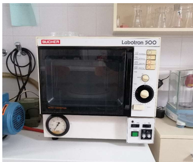
2. ábra: Labotron 500 szakaszos működésű, laboratóriumi mikrohullámú készülék
