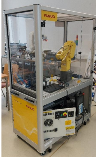
26. ábra Fanuc oktatócella forrás: (saját ábra).
