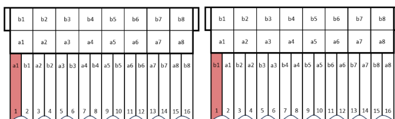
15. ábra A Két CA-MTI-FLAT kábel kiosztása, baloldalon a Phoenix, jobboldalon a HSF típusúval. Forrás: Movella (2020.)
