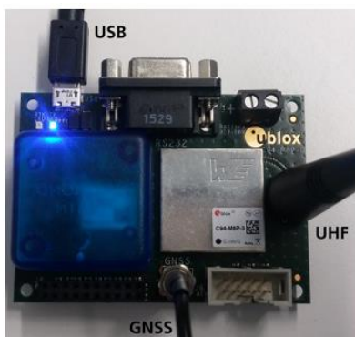
12. ábra A GPS modul bekötése. Forrás: U-BLOX AG. (2021.)
