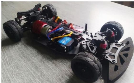
29. ábra: RC autó váz összeszerelt vezérlőegységgel
