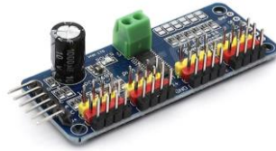
31. ábra: "PCA9685" típusú 16 csatornás szervó vezérlő (www.hestore.hu, 2024.08.24)
