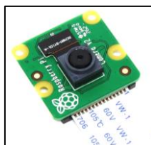
33. ábra: Raspberry Pi Camera Module v2 (thepihut.com, 2024.08.24)
