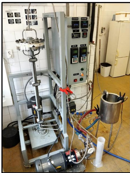
14. ábra VSEP Series L típusú, membránszűrő berendezés és működési elve
