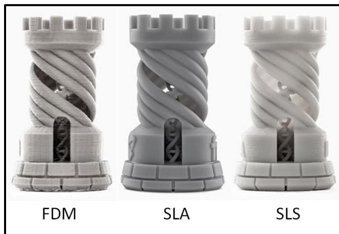
7. ábra FDM – SLA – SLS 3D nyomtatási módszerek összehasonlítása egy modellen ( https://manufactur3dmag.com , 2018)
