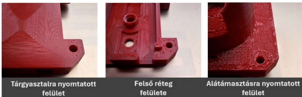
12. ábra. 3D nyomtatásra jellemző felületek
