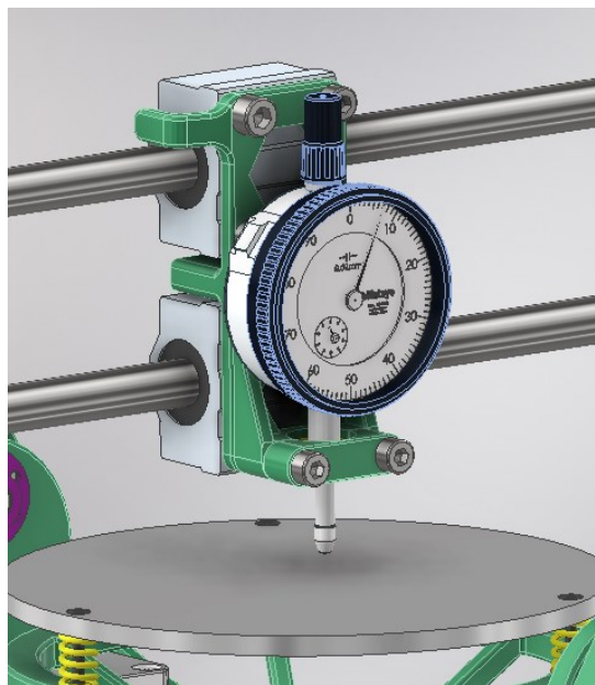
51.ábra. Beméréshez használt mérőóra
