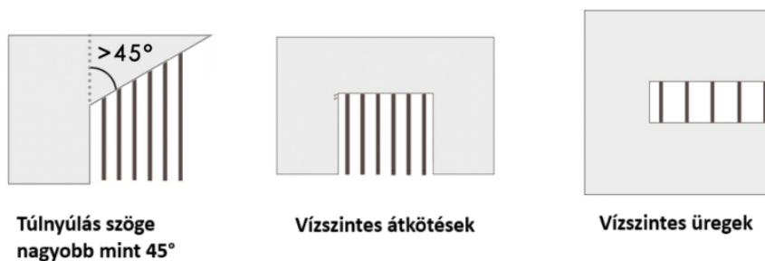
11. ábra. Néhány példa, ahol alátámasztás használata szükséges [24]
