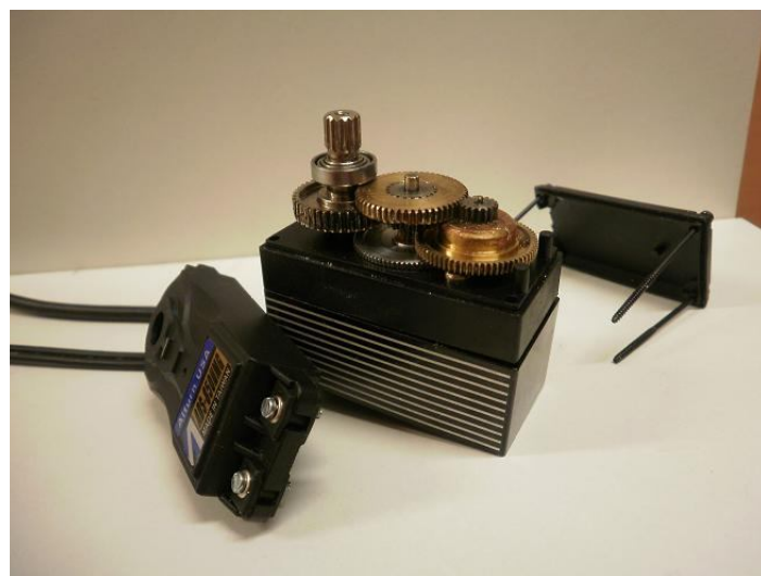
2-23. ábra Szétbontott szervo főbb részei
