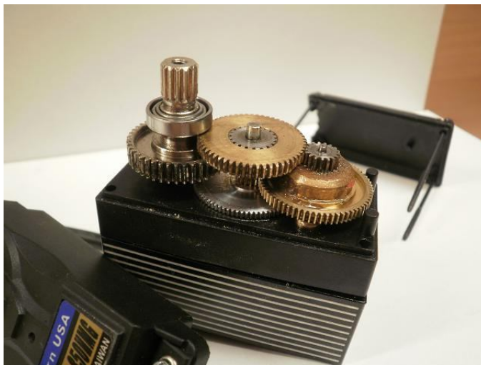
2-24. ábra A servo áttételei
