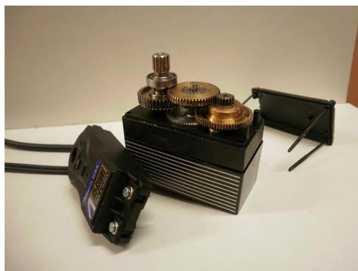
2-23. ábra Szétbontott szervo főbb részei
