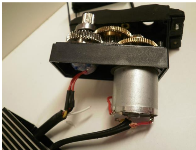
2-25. ábra A motor és a potenciométer
