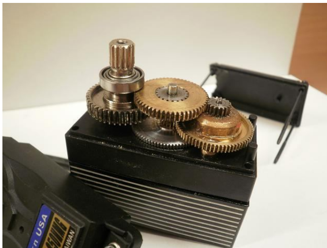
2-24. ábra A servo áttételei
