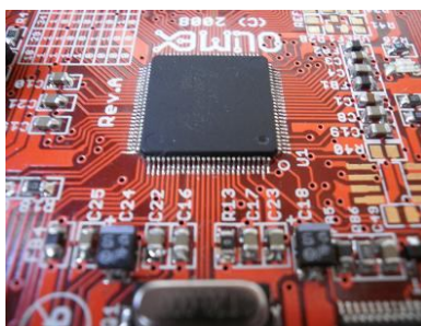
2-12. ábra TMS320 DSP chip beültetve
