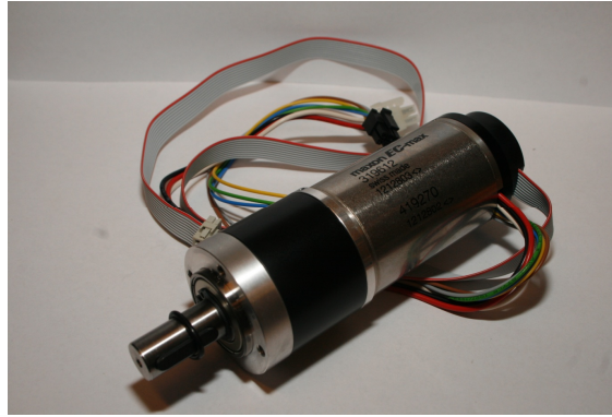
6. ábra: Maxon EC-max 40 BLDC motor (hajtóművel és szögjeladóval szerelve)
