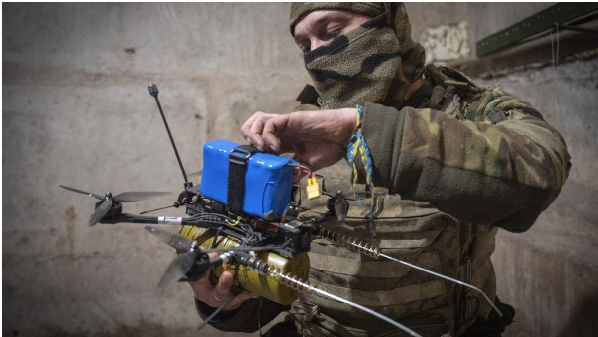
10. ábra Hétköznapi drónra szerelt robbanótest [30]
