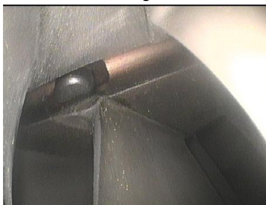
11. ábra: Alacsony nyomású kompresszor lapáttő rész[saját kép]
