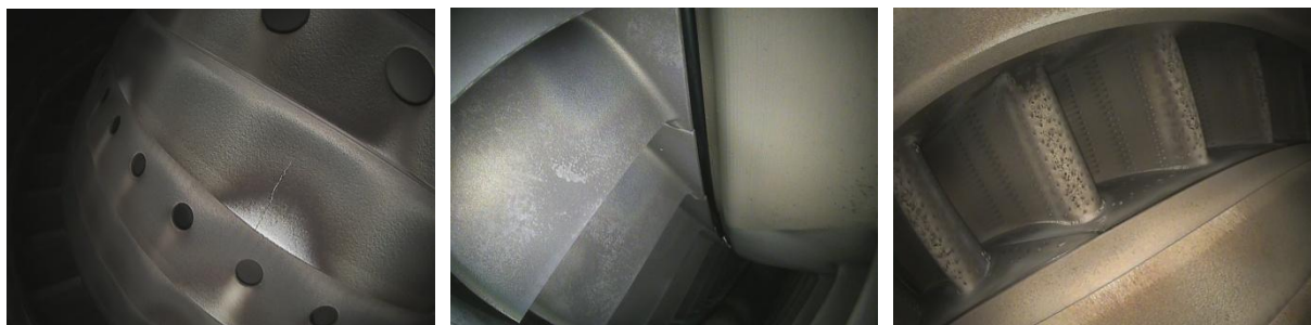
17. ábra: Balra: RM12 égéstér repedése; Középen: RM12 alacsony nyomású turbina forgó lapátsor hibája; Jobbra: RM12 alacsony nyomású turbina álló lapátsor anyaghiba [saját kép]
