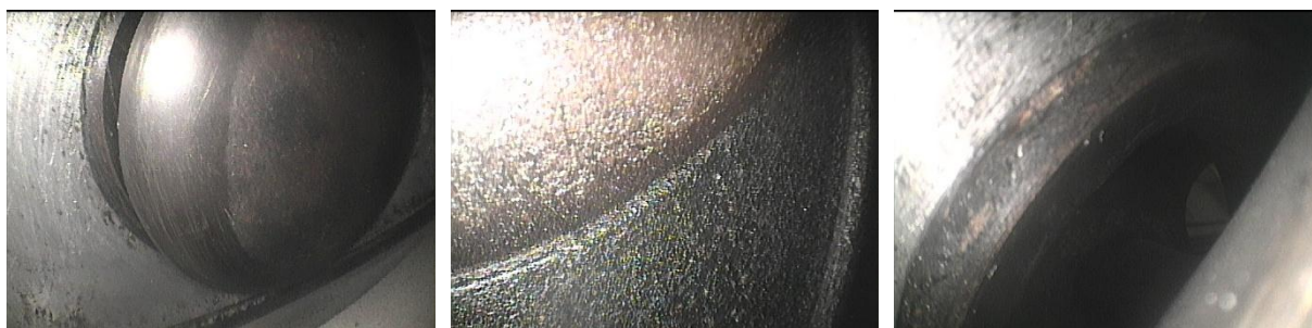
10. ábra: Balra: Nyitott szelep; Középen: Zárt szelep; Jobbra: Szelepülés [saját kép]
