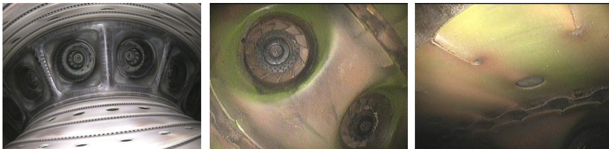
13. ábra: Balra: RM12 égésszektor üzemanyagbefecskendezővel; Középen: TV-3 Lángstabilizátor; Jobbra: TV-3 Hegesztési szegmens [saját kép]
