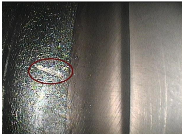
9. ábra: Repedés dugattyútetőn [saját kép]
