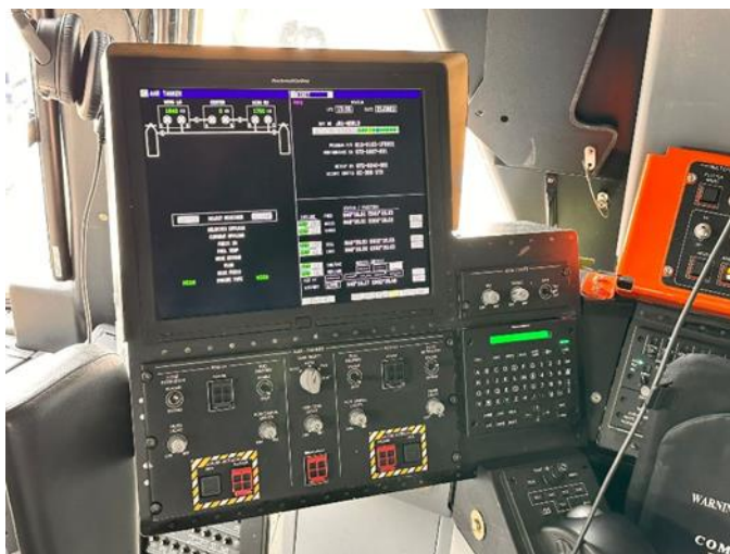
11. ábra A légi utántöltést vezérlő berendezés [23]
