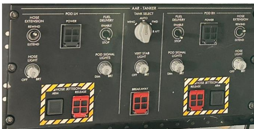
12. ábra Légi tüzelőanyag-utántöltő repülőgép vezérlő panel [23]
