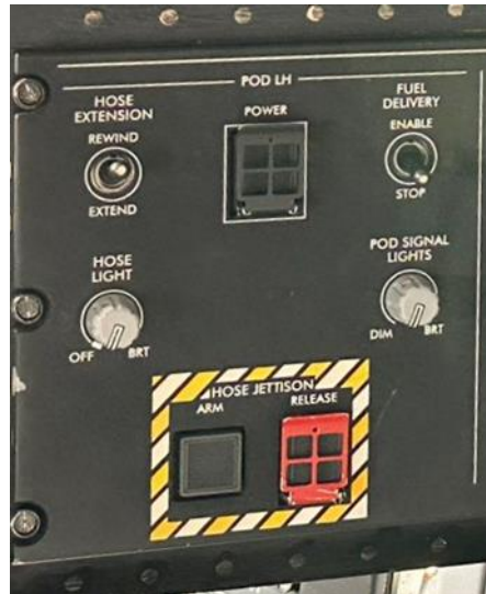
15. ábra A bal oldali függesztmény vezérlő panelje [23]
