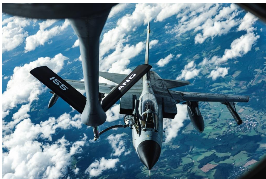
3. ábra BDA átalakító készlettel felszerelt KC-135-ös tanker tankol egy német Tornadot [18]
