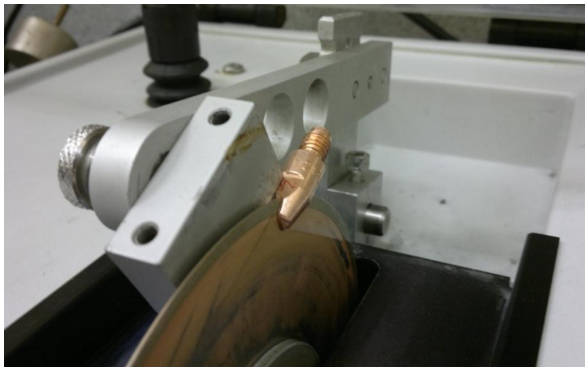
31. ábra. Áramátadó vágása gyémántbevonatú vágókoronggal
