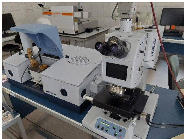
8. ábra: A mérésre használt Bruker Hyperion 2000 FT-IR spektrométer
