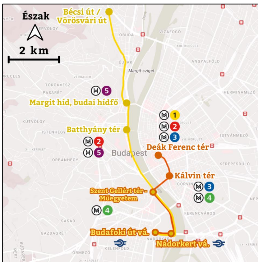
47. ábra: Terv az új vonalszakasz villamoshálózatba kapcsolására (forrás: saját szerkesztés)
