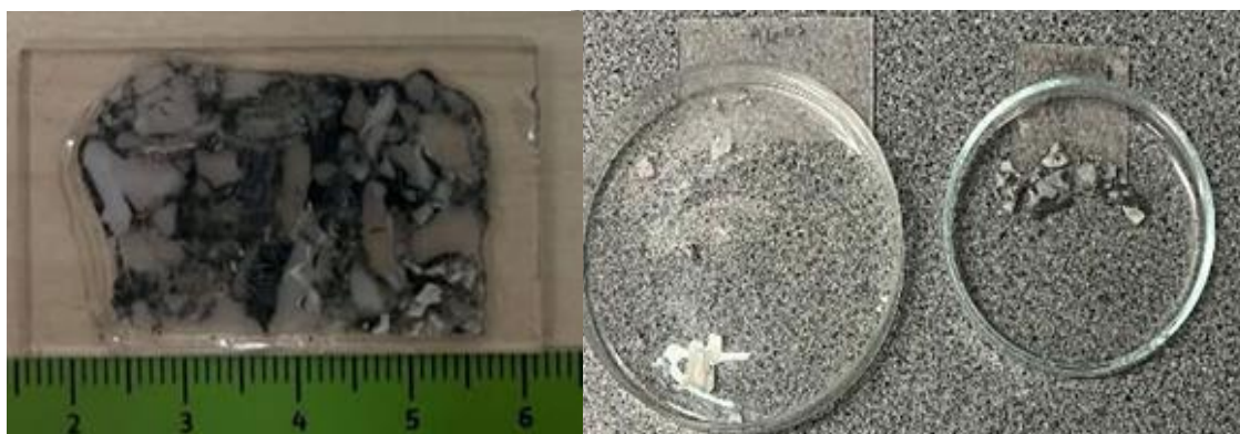
7. ábra. A barit és a kvarc fluidzárványaihoz készült csiszolatok. Baloldalon polírozás után, jobb oldalon mérés előtt
