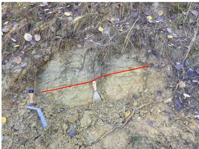
13. ábra: II/17-18. réteghatár ahol drasztikus színváltozás van. A felső 18. réteg homok aleurit váltakozás színváltozással követhető.
