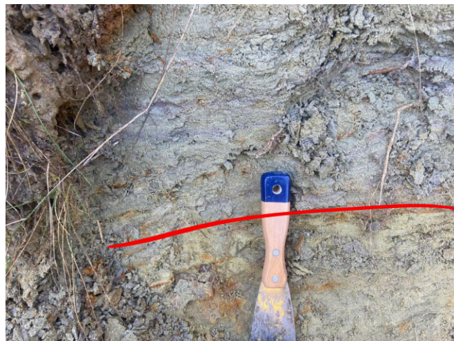
13. ábra: II/17-18. réteghatár ahol drasztikus színváltozás van. A felső 18. réteg homok aleurit váltakozás színváltozással követhető.
