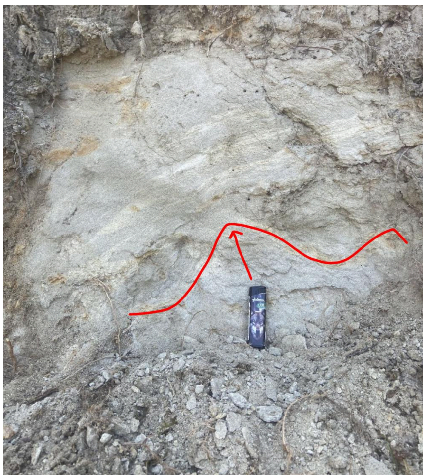
14. ábra: II/19 réteg lencsés keresztlemezesség a vonal felett, piros vonal mentén vízkiszökéssel deformált finomszemű homok réteg.
