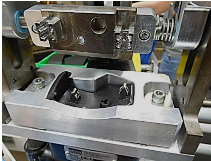
4. ábra. Oberteil már kapcsozott állapotában a kapocsbenyomó prés alsó fészében
