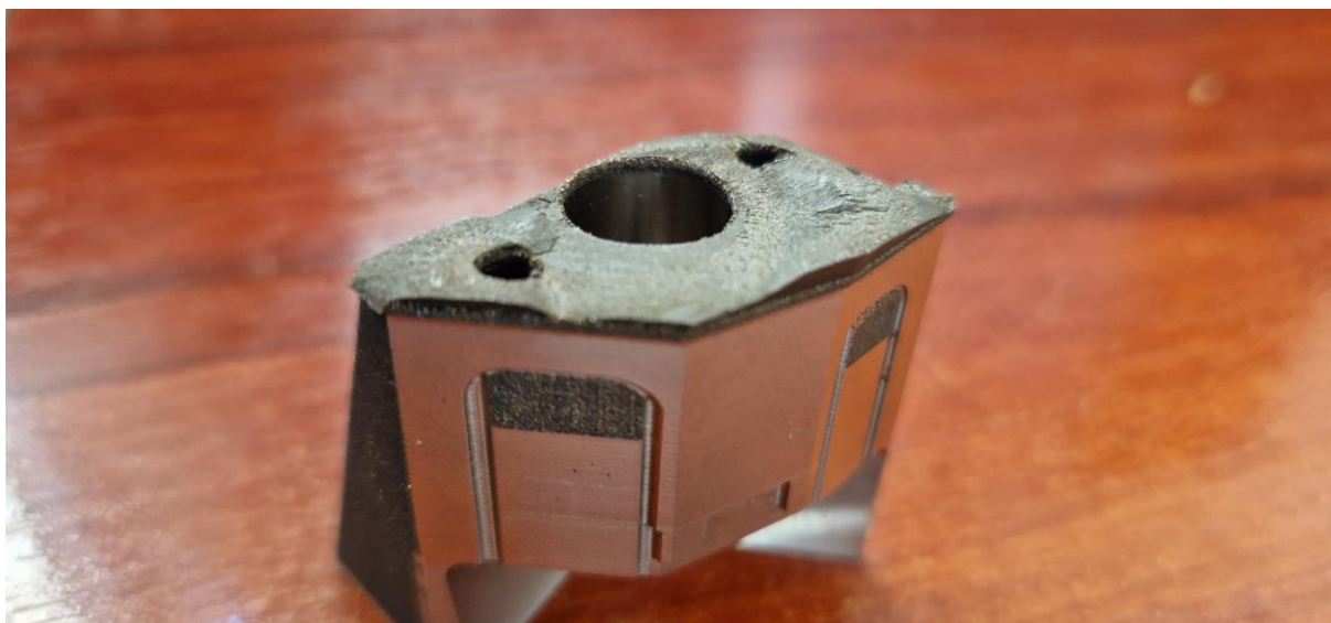
18. sz. ábra. Rétegtapadási problémából adódó törés
