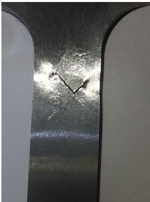
30. sz. ábra. Szakítópróbatest felületi repedése
