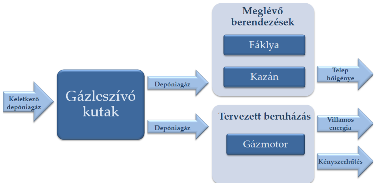
7. ábra: A gázmotoros depónia-hasznosítás alapsémája
