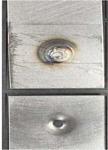
25. ábra: 4 mm átmérőjű, 60 A áramerősségű próbatest a szakítás után
