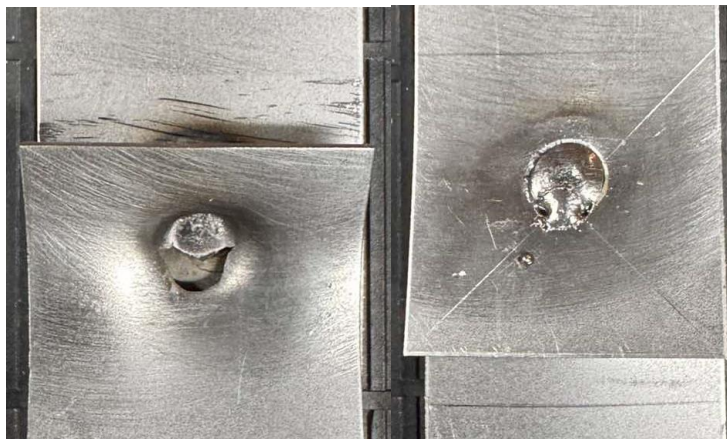
30. ábra: 6 mm átmérőjű, 50 A áramerősségű próbatest a szakítás után
