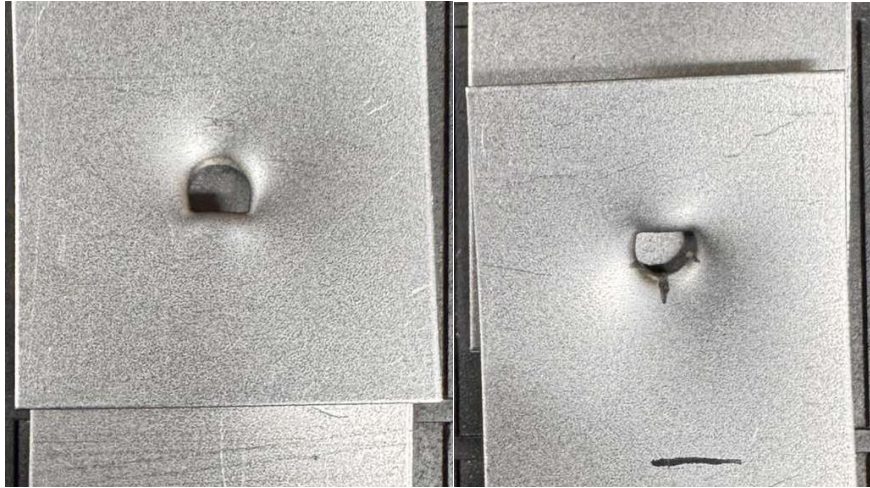
18. ábra: 101. sorszámú próbatest állapota szakítás után
