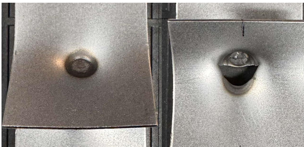
23. ábra: 106. sorszámú próbatest állapota szakítás után
