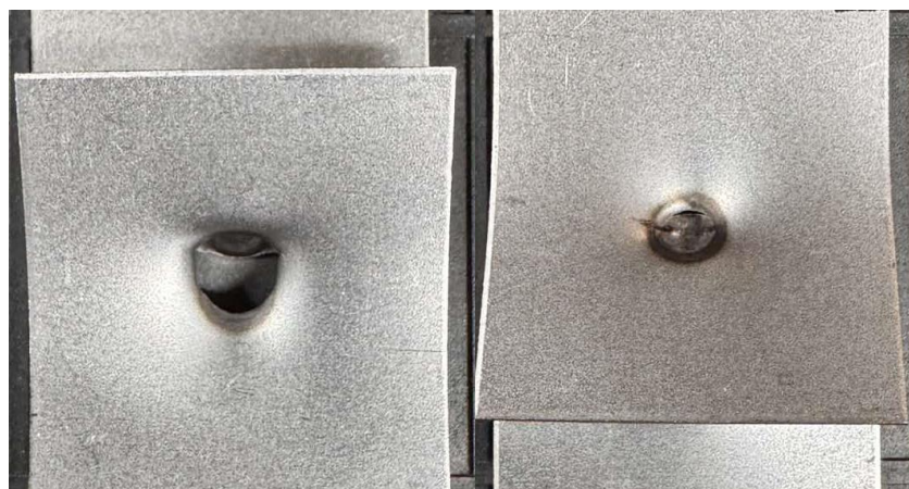
22. ábra: 105. sorszámú próbatest állapota szakítás után
