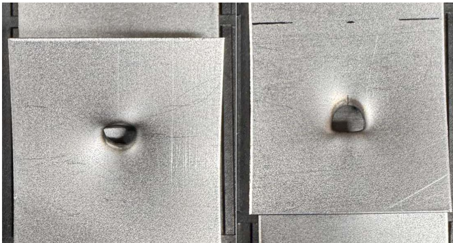
19. ábra: 102. sorszámú próbatest állapota szakítás után
