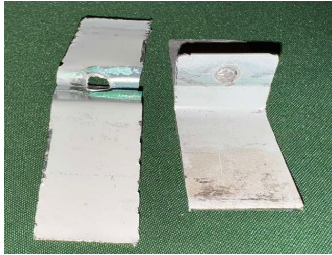
12. ábra: Szakítóvizsgálat utáni állapot bal, előtte jobb oldalt
