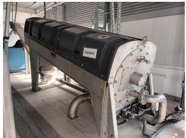
12. ábra: Törökszentmiklós szennyvíztelep csigaprés
