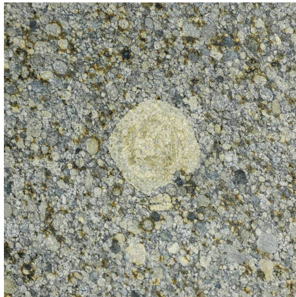
3. ábra. Egy közönséges L4 típusú kondrit, a NWA 14150 meteorit belső szerkezete. A képen jól látszanak a kondrumok, ami azt is jelenti, hogy az idők során kevés sokkhatás érte és nem mállott el. Az L4 besorolás a csekély mértékű termikus változásokat jelenti. A kondrumok általános mérete néhány mm, de középen egy nagyobb is látható. A kondrumok körül látható vékony porsáv az eredeti protoplanetáris korong anyaga. Szklenár Tamás fotója.
