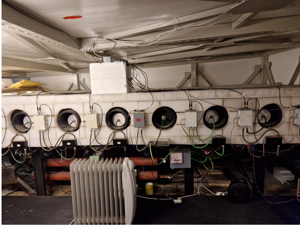
1.2. ábra. Saját készítésű kép a neutrontektorról 2023.08.04-én. A képen 6 cső látható a nyolcból, illetve az őket körülvevő szigetelő réteg.
