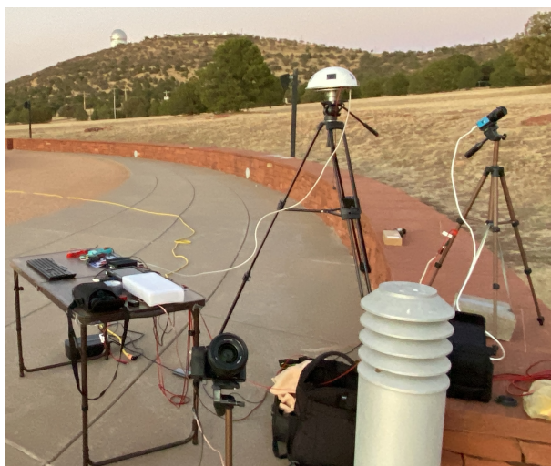
3.1. ábra. Május 30-án a McDonald Obszervatórium látogatóközpontja mellett felállított kamerák. A megfigyelésekhez használt három kamera az AllSky7 (középen), a DMK (jobbra) és a Sony \alpha 7 (alul). A Hobby-Eberly Teleszkópot (a háttérben) nem használták a Tau Herculidák megfigyelésére. A fotó készítette: RM.
