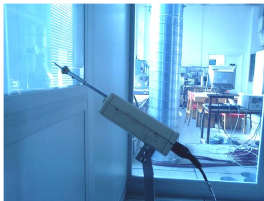
7. ábra: Hődrótos mérőszonda
