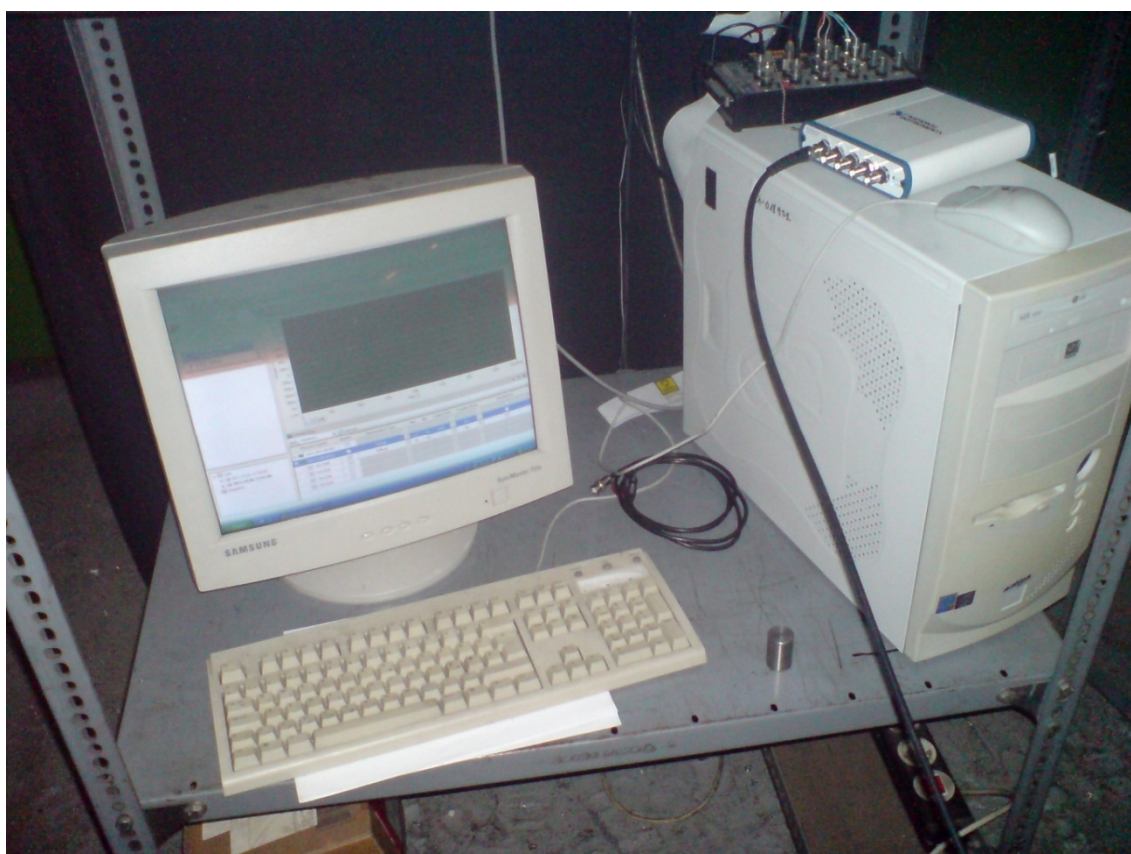
8. ábra Számítógép függvénygenerátorral a belsejében és USB-s I/O eszközzel a tetején
