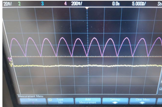
3.13. ábra. Tesztmérés a kétrétegű PCB-n 100 Hz-es bemeneti jellel. Sárga: bemeneti jel, lila: kimenet.
