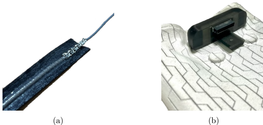
5.3. ábra. Az előzőleg használt (a) elasztikus vezeték és rézhuzal csatlakozás, valamint (b) interfész csatlakozó.
