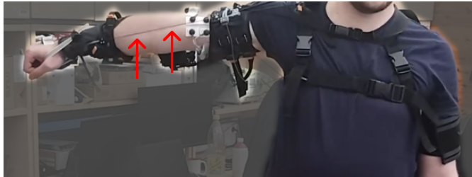
(a) A kar kezdeti, 0 fok körüli kifizített állapota. Az ábrán továbbá megfigyelhető a piros nyilakkal jelölt részen az exoszkeleton flexor rugója (a fekete színű ejtőernyőszén) is.
