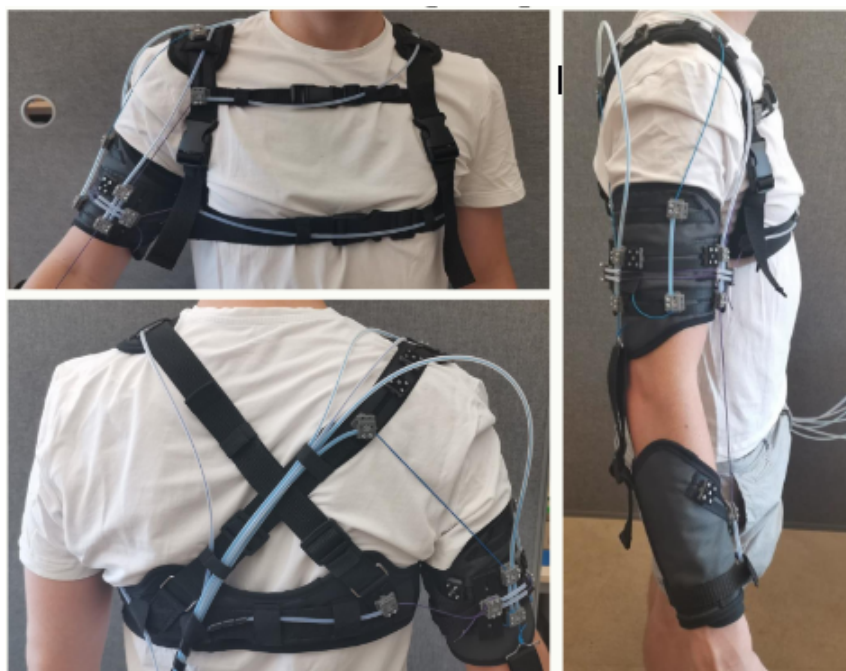
4.1. ábra. Az ábra a Laborban épülő exoszkeleton szerkezetét mutatja be. A világoskék színű részek azok a hüvelyek, amelyekben az ejtőernyőzsinór fut. A zsinórok sötétkékekkel vannak ábrázolva, a motorok nincsenek jelen ezeken a képeken, a fekete heveder pedig az eszköz testhez való rögzítésére szolgál. Ahogy a képen látható, ez egy viszonylag gyorsan és könnyen felvehető, a mozgást alig vagy egyáltalán nem korlátozó, de elhanyagolható súlyú eszköz. (Az ábra forrása: Érzékelő Robotika labor.)
