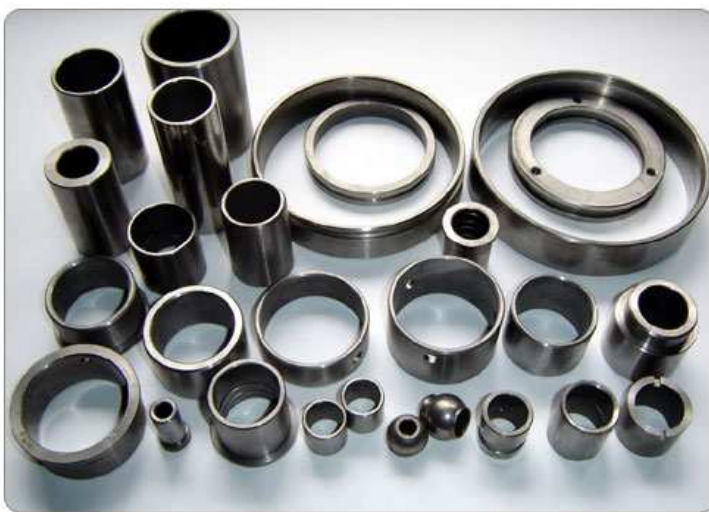
1.ábra. Porkohászati gyártmányok
