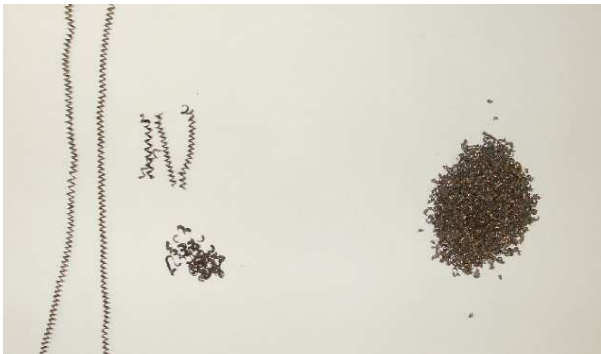
29.ábra. C45 és porkohászati anyag forgácsolásakor kialakuló forgácsalakok
