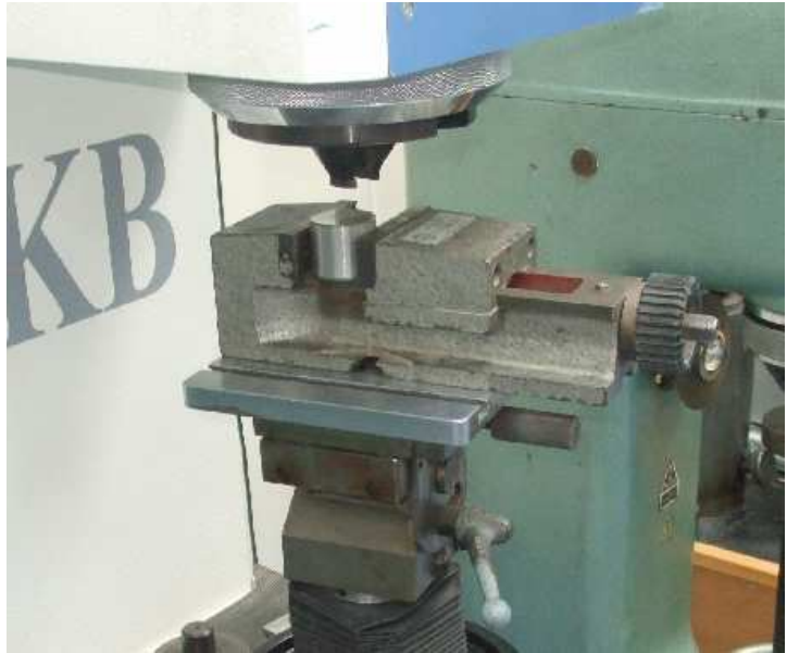
8.ábra. Próbatest befogása keménységméréshez
