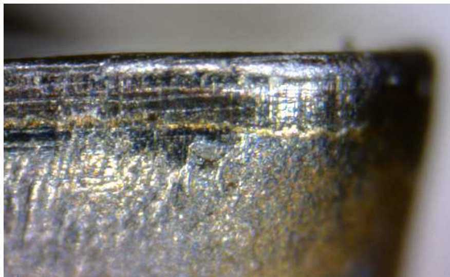
30.ábra. Jól látható hátkopás a forgácsoló lapkán
