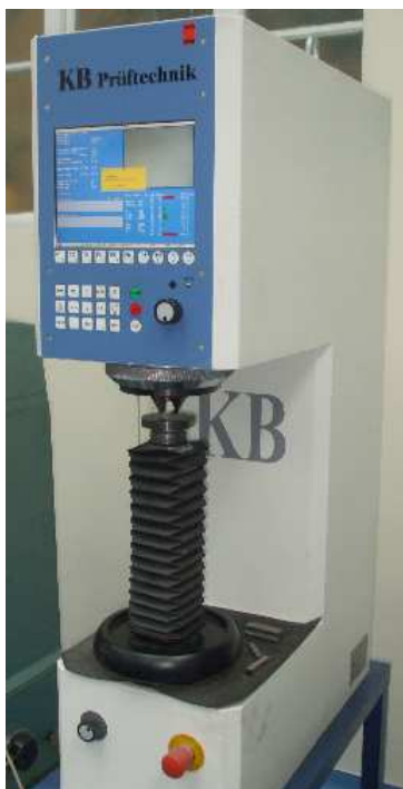
7.ábra. KB Prüftechnik DKD-K keménységmérő gép
