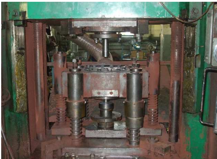
3. ábra. Présgépre szerelt sajtolószerszámok
