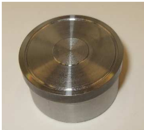
25.ábra. Próbatest karcolási kísérlet után
