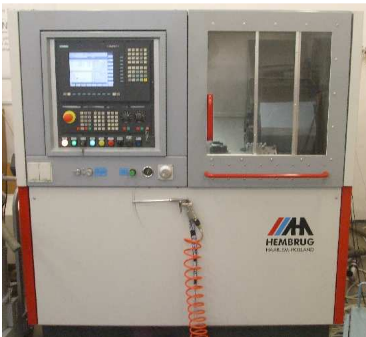
11. ábra. Hembrug nagy pontosságú eszterga
