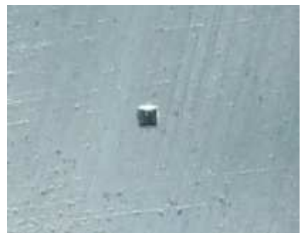
10.ábra. Vickers-keménységmérési lenyomat a próbatest felszínén
