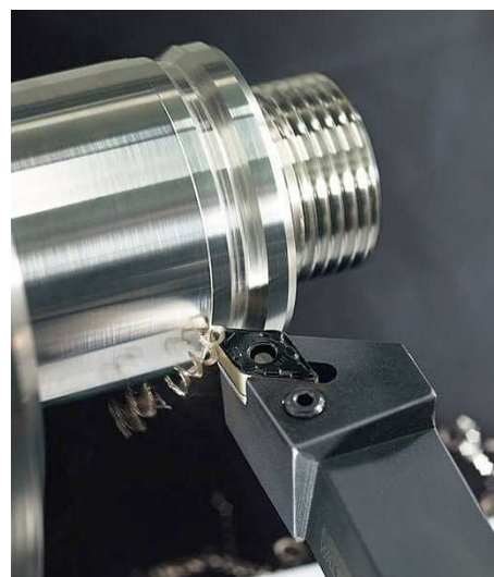
2.ábra. Esztorgálási folyamat
