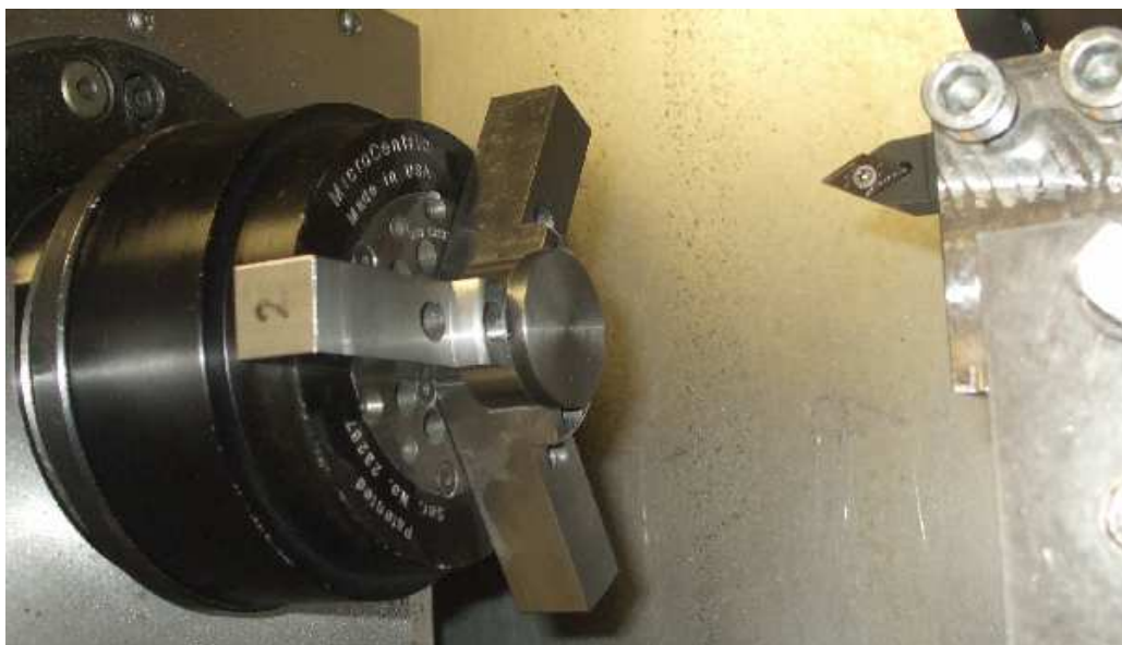
23.ábra. Karcolási kísérlethez előkészített próbatest
