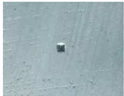
10.ábra. Vickers-keménységmérési lenyomat a próbatest felszínén
