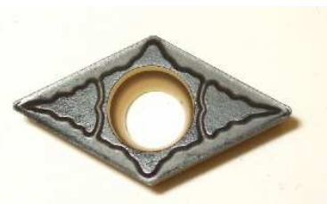
22.ábra. Karcolási kísérlethez használt váltólapka
