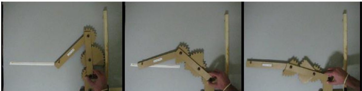
50. ábra Nyílt láncú mechanizmus egyenesbe vezetésének megvalósított példája
