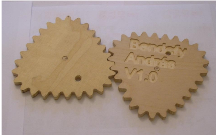
45. ábra A legyártott háromágú fogaskerekek
