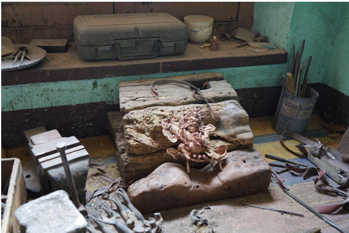
13. kép Az képen látható öntvény felületi kidolgozása elkészült, a következő fázisban a további tisztítási és cizellálási folyamatok következnek. Forrás: saját fotó.
