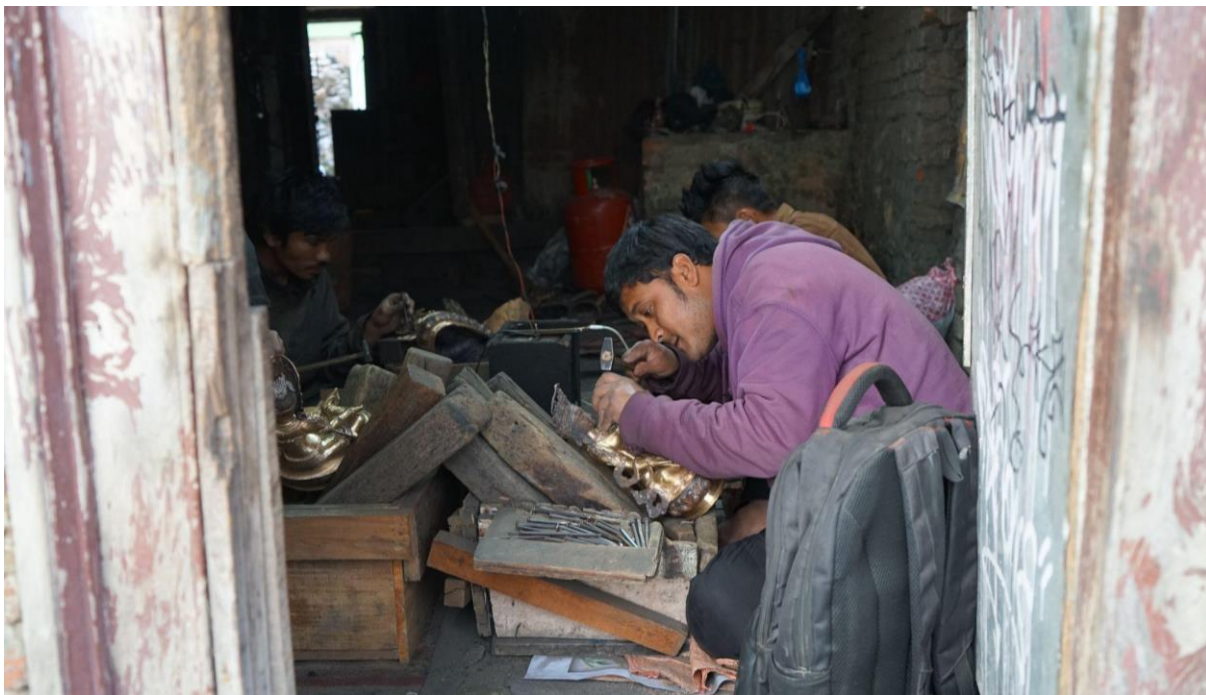
15. kép Az öntvények felületének kidolgozását is sokszor erre specializálódott munkások végzik, nem pedig a mesternek tekintett személy. Forrás: saját fotó.
