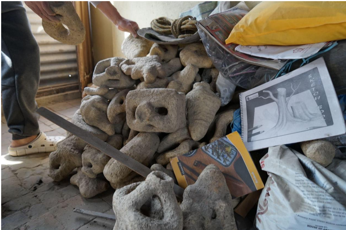
11. kép Egy másik patani mester műhelyében található öntőformák. Forrás: saját fotó.
