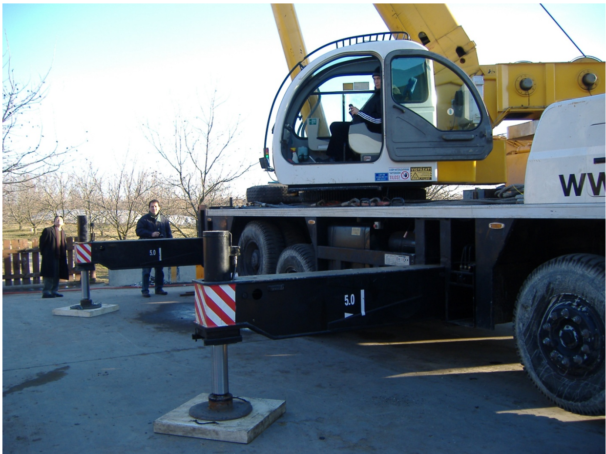
1.1. ábra. Autódaru munkavégzés közben, kitolt gerendákkal
