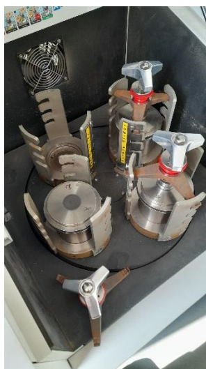
2. ábra RETSCH PM400 golyósmalom
