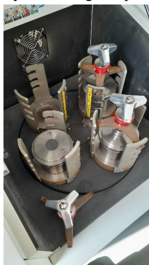
2. ábra RETSCH PM400 golyósmalom
