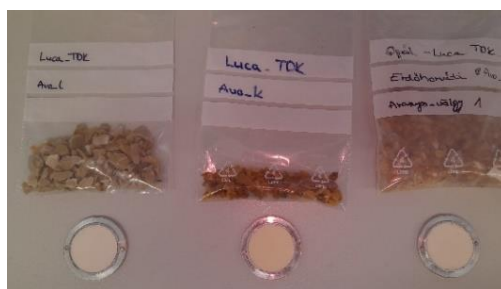
3. ábra Aranyos-völgyi opál preparátuma xrd mérésre
