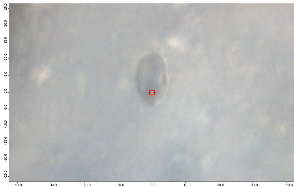
29. ábra: Olvadékszárvány olivinben (0.0-10.0=1 mikron); forrás: saját felvétel
