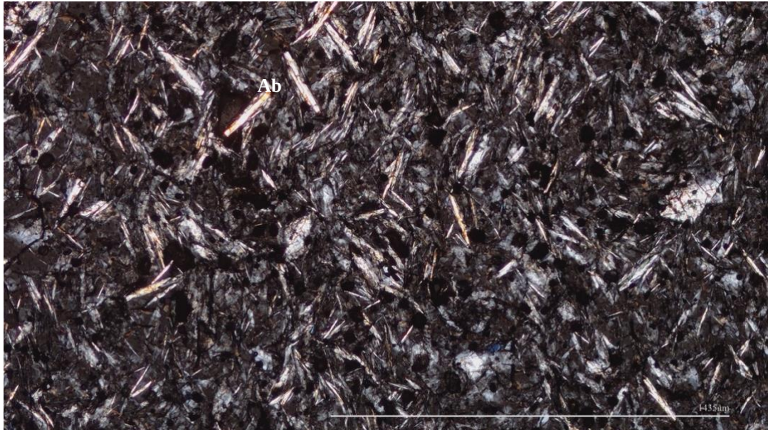
12. ábra: Obszidián vékonycsiszolat keresztezett nikolok alatt; szövet; forrás: saját felvétel
