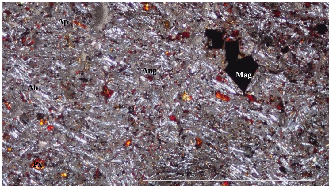
21. ábra: Andezin andezit vékonycsiszolat; keresztezett nikolok alatt; szövet titán tartalmú magnetittel; forrás: saját felvétel
