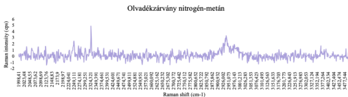
20. ábra: Salak Raman: Olvadékszárvány: nitrógen (2327), metán (2913), víz (3250); forrás: saját grafikon
