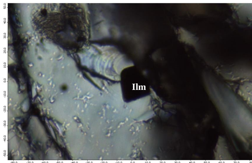
19. ábra: Salak Raman-felvétele: Ilmenit olivin bezáró ásványban (0.0-10.0=1 mikron); forrás: saját felvétel
