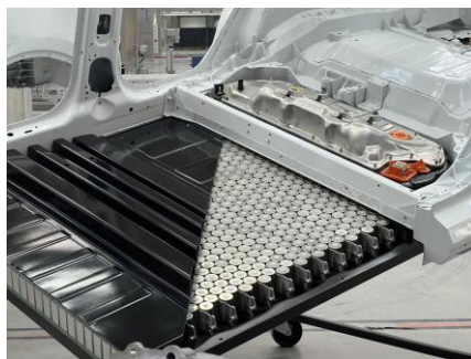
3.2. ábra Akkumulátor csomag a padlólemezben, metszeti kép [26]
