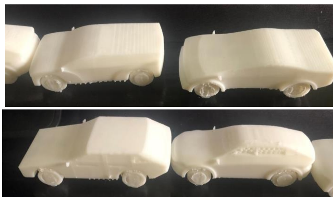
4.14. ábra Makettek első 3D nyomtatott verziói mind a négy formatervre
