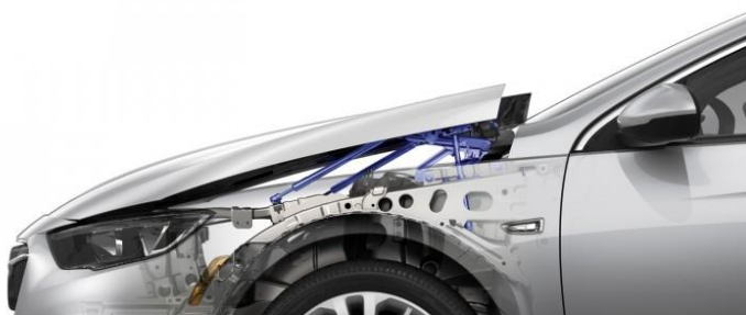
3.15. ábra Motorháztető emelő, gyalogos védő mechanizmus szerkezeti ábrája [35]
