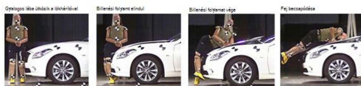
3.16. ábra Motorháztető emelő, gyalogos védő mechanizmus működés közben [36]
