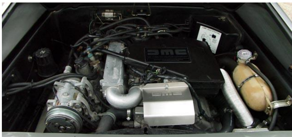
1.6. ábra V6 PRV motor beépítve a DMC-12-es motorterébe, az autó hátuljába [5]
