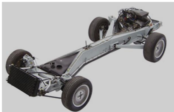
1.5. ábra Y-alváz, a Lotus Esprit S1 összeállítása [4]
