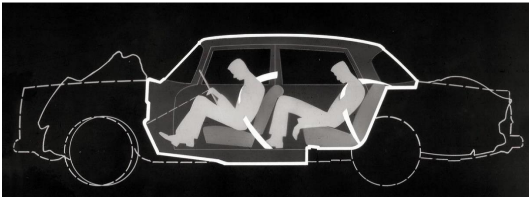
3.18. ábra Barényi-féle biztonságos személygépjármű koncepció merev belső szerkezettel és ütközési energia elnyelő nyúlványokkal [38]
