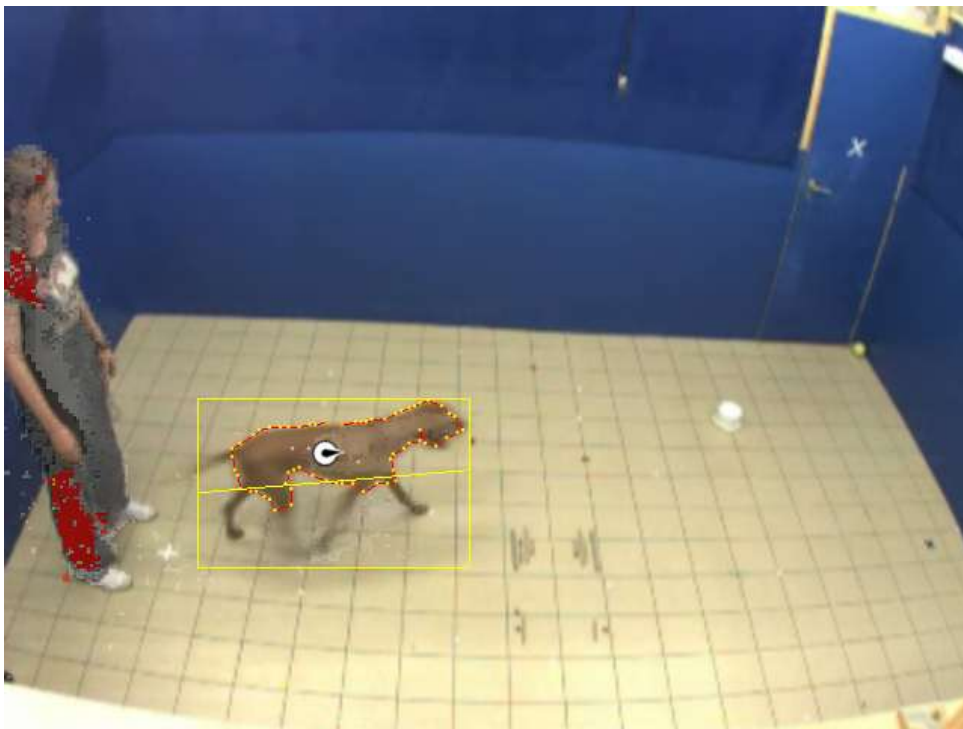
3. ábra Élőlények mozgásdetektálása: a pirossal jelölt területeket a régi rendszer beolvasztotta volna
