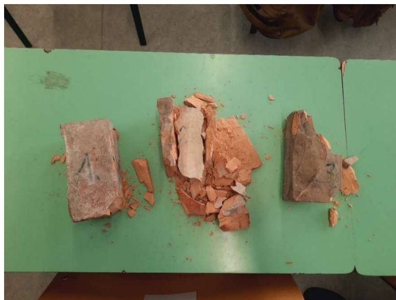
9. ábra: A 3 díszítő téglá a hidraulikus nyomóvizsgálat után.
