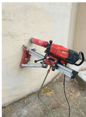
19. ábra: Betonminták vételezése fúrással (forrás: szerző fényképe, készítés ideje: 2024.06.12)
