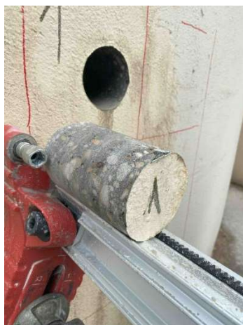
19. ábra: Betonminták vételezése fúrással (forrás: szerző fényképe, készítés ideje: 2024.06.12)
