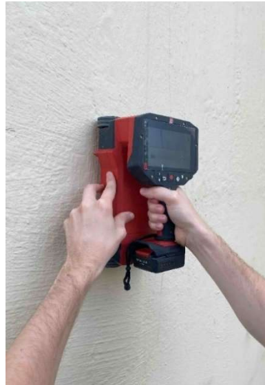
23. ábra: Mágneses vizsgálat (forrás: szerző fényképe, készítés ideje: 2024.06.12)
