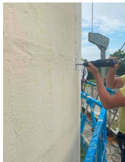
18. ábra: Roncsolásmentes szilárdsági vizsgálatok Schmidt kalapáccsal (forrás: szerző fényképe, készítés ideje: 2024.06.13)
