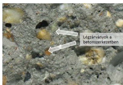
20. ábra: Légzárványok a szerkezetben (forrás: ORISOFT Mérnöki Építő és Tanácsadó Kft: A mezőkovácsházi vasbeton silók statikai állapotáról készített szakvélemény)
