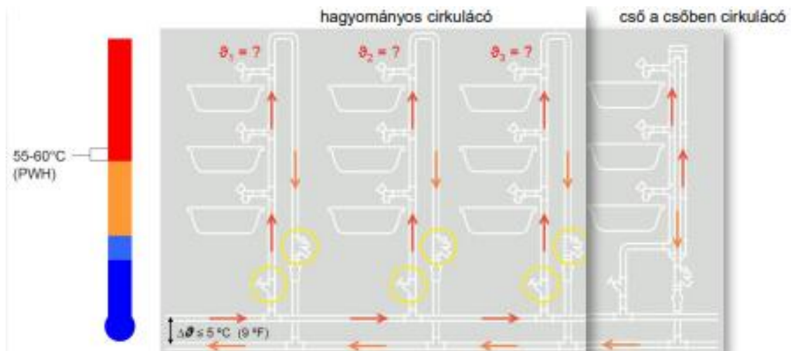
17. ábra: Hagyományos és cső a csőben cirkuláció összehasonlítása, forrás: (Zoltán N. , 2021)
