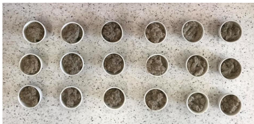
13. ábra: Mintaelőkészítés hamutartalom méréséhez
