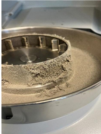
12. ábra: Mintaelőkészítés darálással
