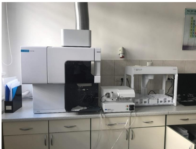
15. ábra: ICP készülék
