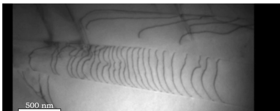
1.1. ábra. CrMnFeCoNi Cantor-ötvözet (HEA) TEM lamella terhelése során rögzített felvétel. A fekete vonalak a diszlokációvonalak, melyek alakján jól látható a véletlenszerű atomszerkezet következtében a fluktuációk.[4]
