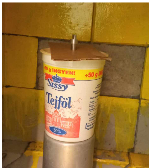
5. ábra. A kisméretű ^{60}\text{Co} minta az első elrendezésben. Alul a germánium detektor burkolata látható rajta az állványal, a háttérben pedig az ólomkamra.
