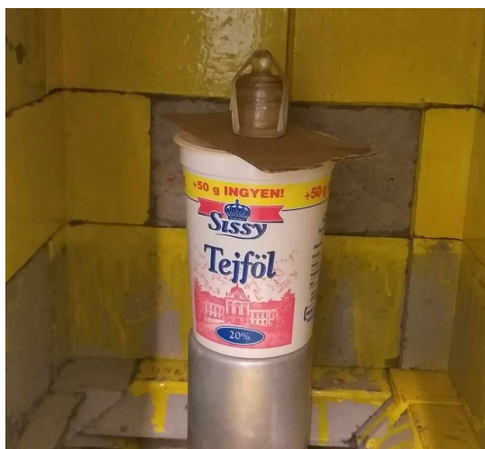
12. ábra. ^{232}\text{Th} tartalmú minta a detektor felett 12.5cm-el
