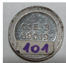
20. ábra. A ^{137}\text{Cs} tartalmú minta, mely nagyjából 3 cm széles
