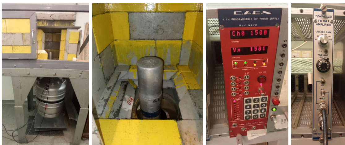
4. ábra. Balról jobbra: a detektor kívülről majd az ólom kamrán belül, a nagyfeszültség-forrás végül a jelerősítő berendezés
