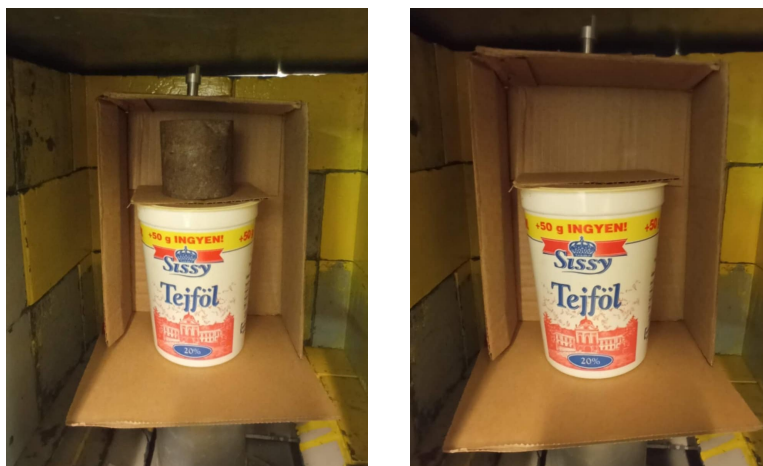
18. ábra. Gránithenger átvilágítása ^{60}\text{Co} tartalmú mintával a létrehozott állványon
