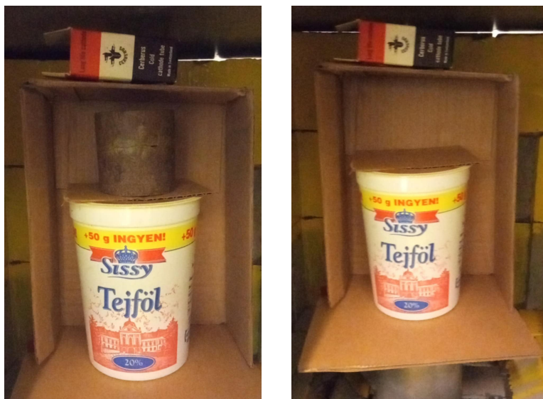
19. ábra. Gránithenger átvilágítása ^{226}\text{Ra} tartalmú mintával
