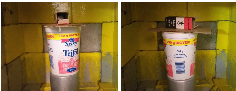
6. ábra. A rádium minta a kartondobozban, a ^{60}\text{Co} mintával megegyező elrendezésben
